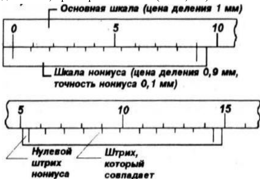
Рисунок 2 – Определение размеров с помощью ШЦ-1
